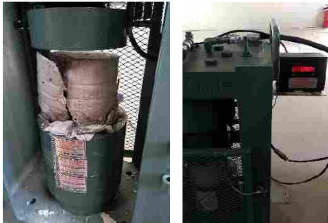
Fotografía 13. Prueba de concreto a la Compresión, Tecnológico de Estudios Superiores de Ixtapaluca, 2019. Elaboración propia.
