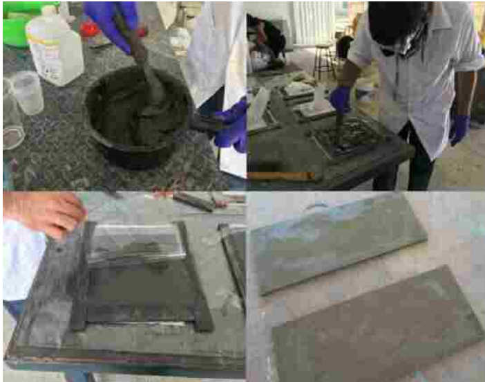
Figura 5. Fabricación de muestras del panel de cemento.
