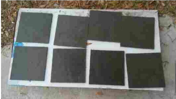
Figura 7. Curado de muestras del panel de cemento.
