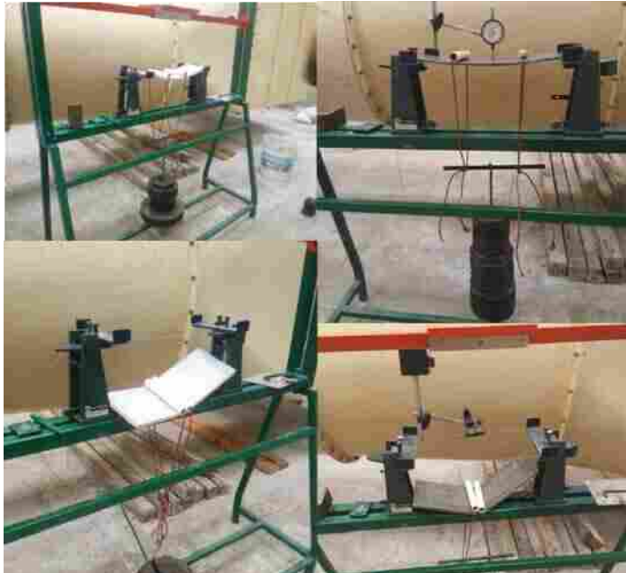
Figura 14. Flexión de los paneles.
