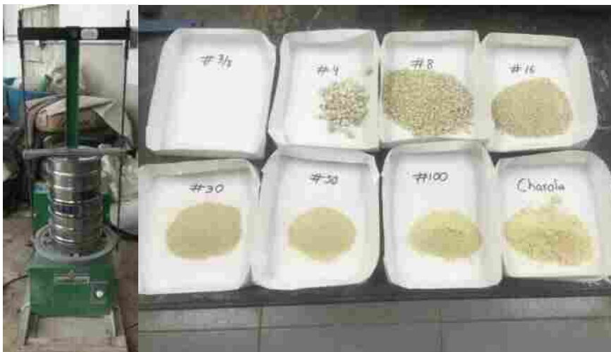
Figura 2. Caracterización del agregado fino.
