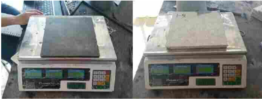
Figura 8. Densidad y peso de los paneles.
