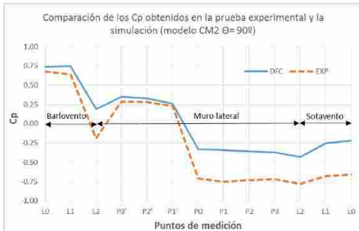
Figura 14: Comparación de C_p obtenidos de ensayos experimentales y mediante CFD (elaboración propia).
