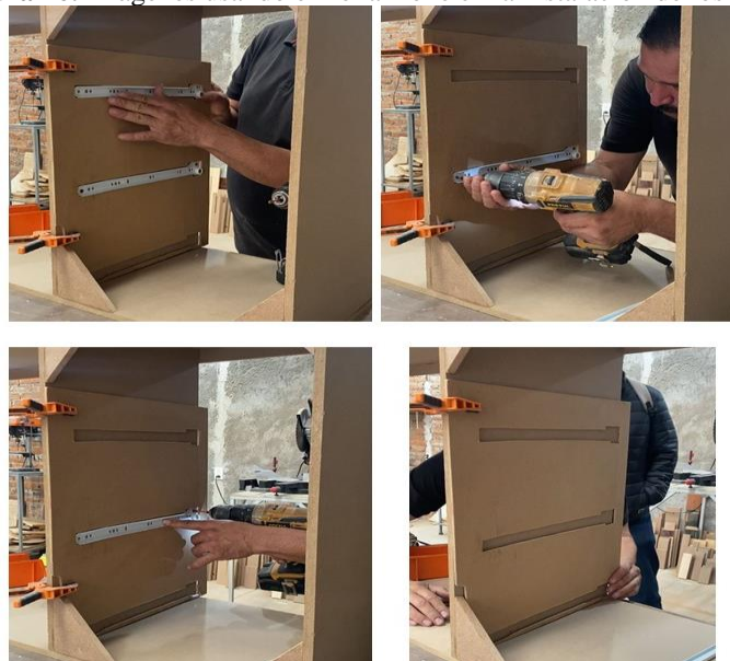
Figura 16. Imágenes usando el Poka Yoke en la instalación de los rieles.
