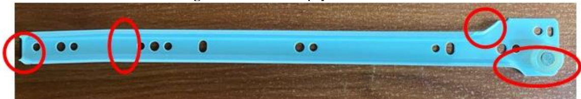
Figura 12. Puntos de apoyo de los rieles.
