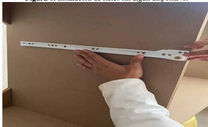
Figura 6. Instalación de rieles sin algún dispositivo.
